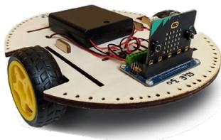
Ziel: Die Teilnehmer\*innen bauen selbst die Karosserie einer Robo4earth zusammen. Dazu muss Elektronik zusammengebaut und an ein paar Stellen gelötet werden. Jede/r Teilnehmer\*in erhält eine Robo4earth inklusive Elektronik (aber ohne Microbit).
